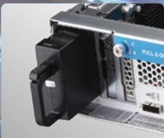
Caché de escritura NVRAM protegido con una batería
