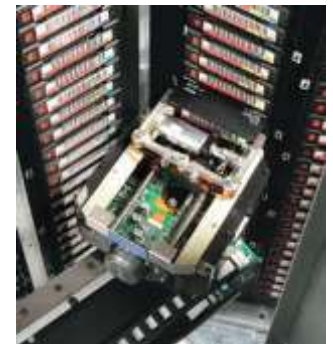
La robótica nunca deja el LRM para acceder a los cartuchos en el MEM, asegurando tiempos de acceso rápidos y alta confiabilidad.
